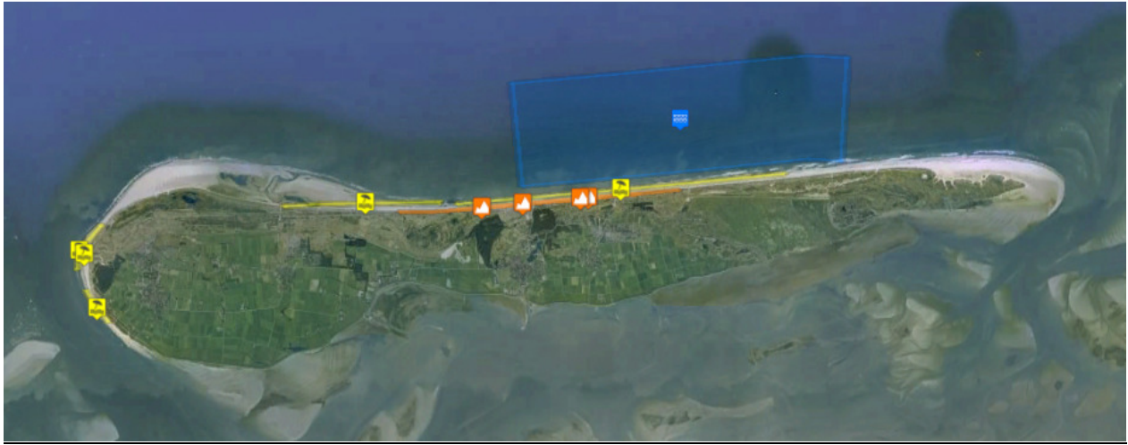
Figuur 4 Locaties zandsuppleties vóór 2000 (geel = strandsuppleties, blauw = onderwater- en vooroeversuppleties, oranje = zeevaartse duinverzwaring)
