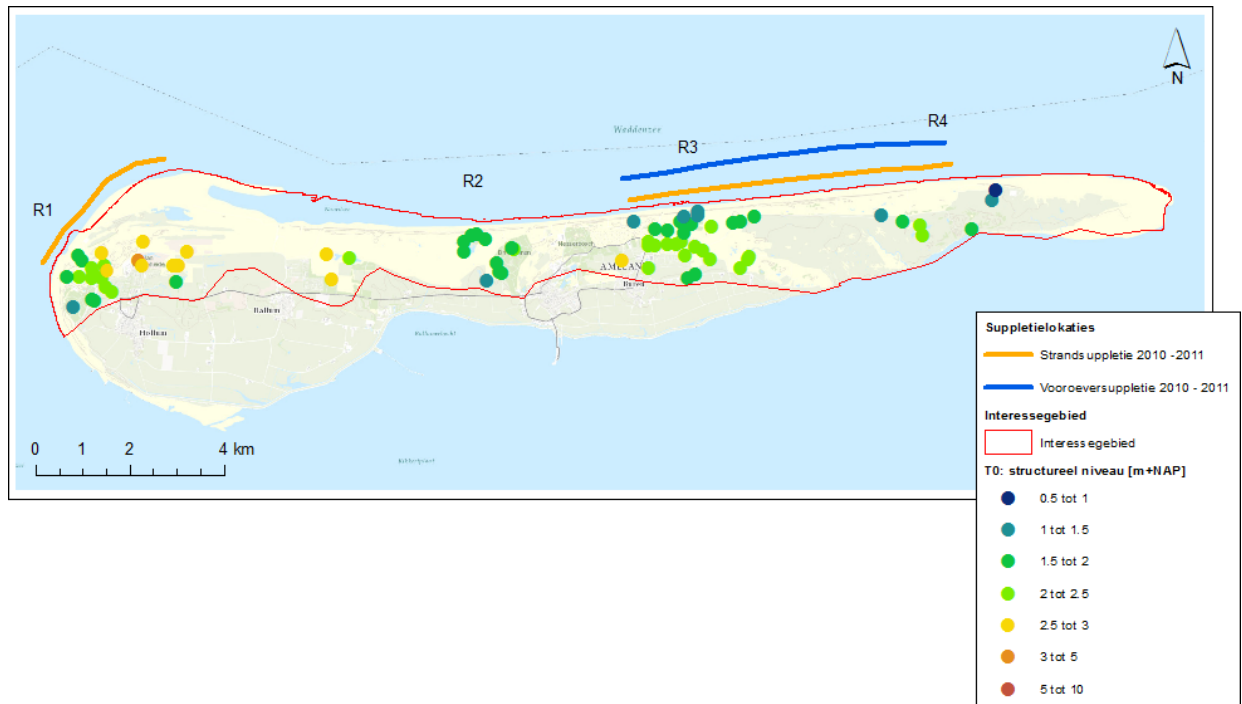
Figuur 8 Structureel niveau grondwaterstand T0 (referentiesituatie)
